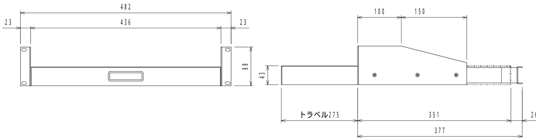
材質 : SECC1.0/1.6/2.3mm (クロムフリー鋼板)
