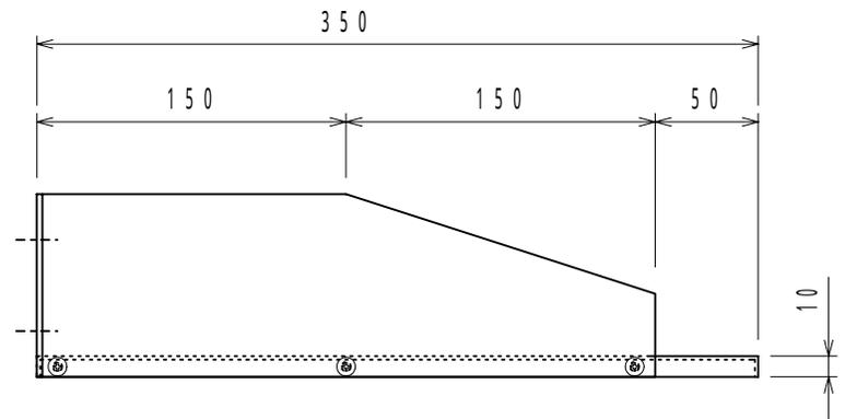
材質 : SECC 1.6mm (クロムフリー鋼板)
