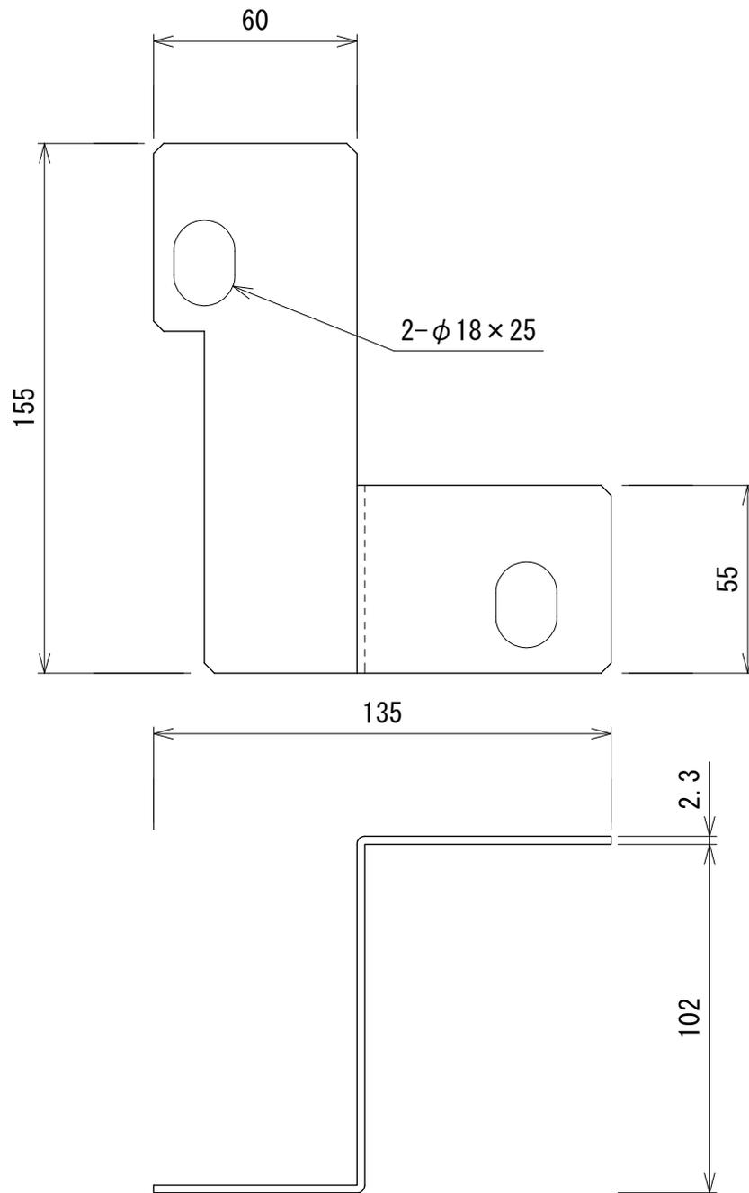
材質 鋼板製t=2.3mm
