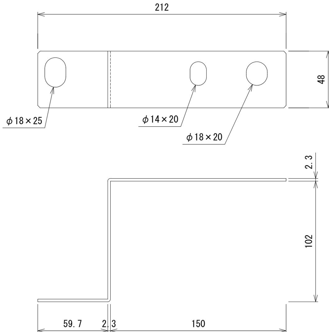
材質 鋼板製t=2.3mm
