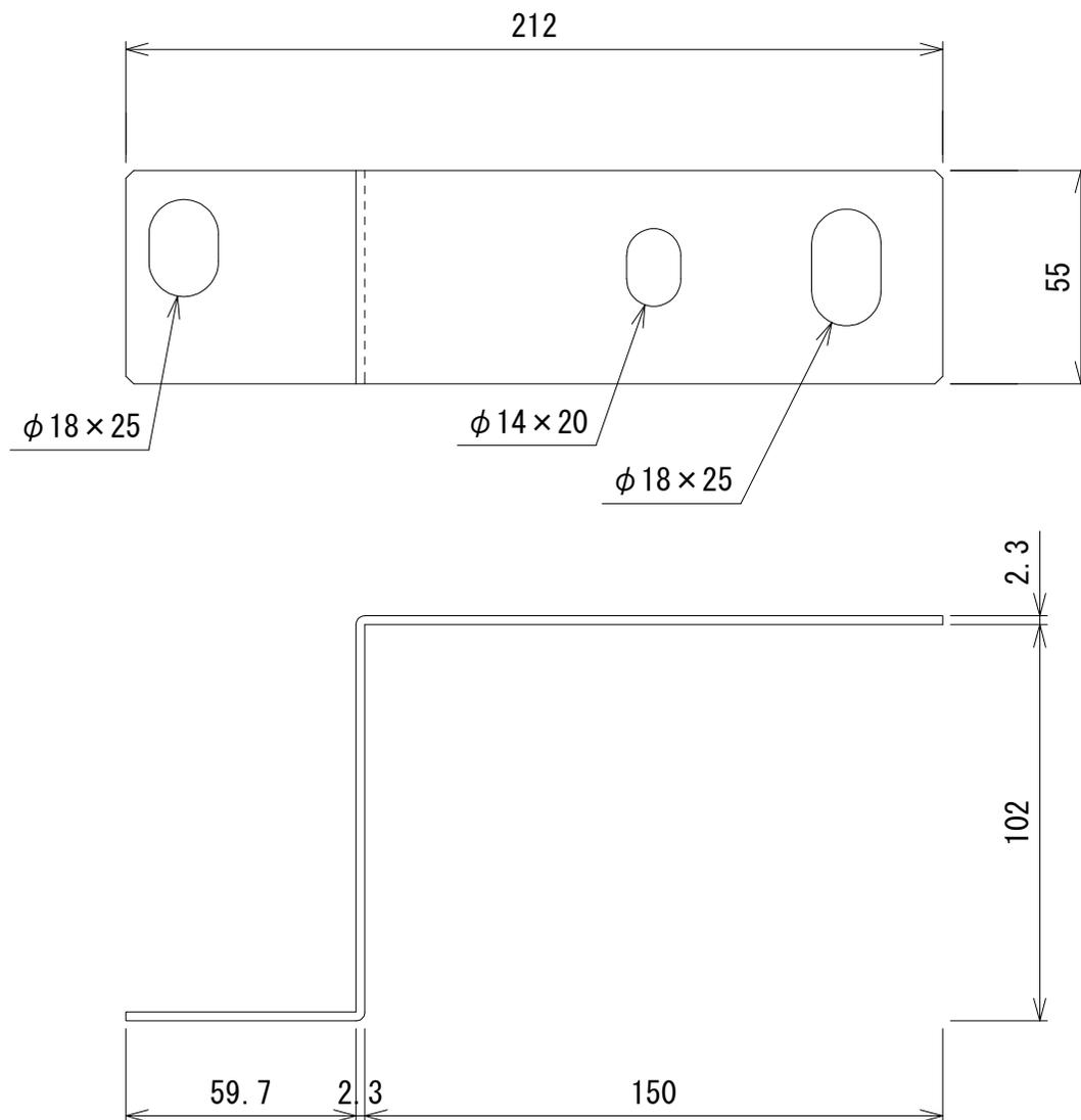
材質 鋼板製t=2.3mm
