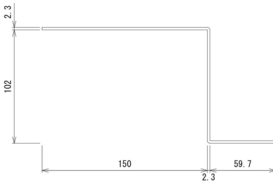
材質 鋼板製t=2.3mm
