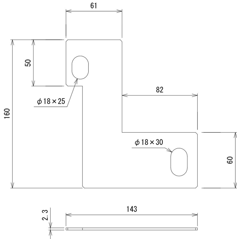
材質 鋼板製t=2.3mm
