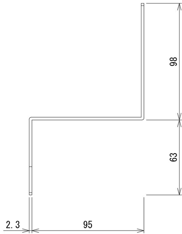
材質 鋼板製 t=2.3mm
