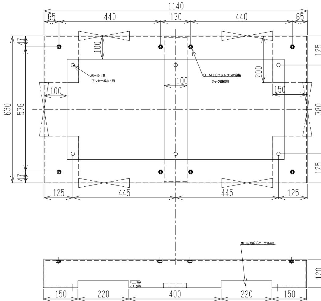
材質 : SECC3. 2mm (クロムフリー鋼板)
