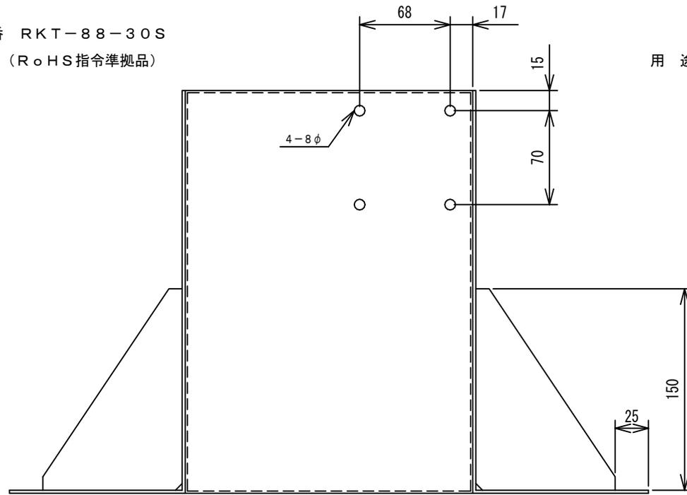
材質 : SECC1.6/2.0mm (クロムフリー鋼板)
