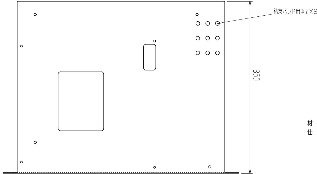
材質 : SECC 1.6 / 2.3mm (クロムフリー鋼板)
